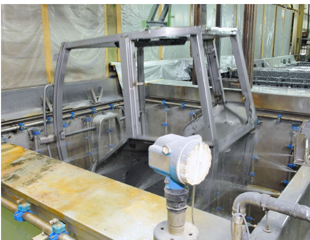
Abbildung 2: Kathodische Tauchlackierung: In aufeinanderfolgenden Tauchbecken werden die Strukturen der Traktorkabinen sowie Einzelteile vorbereitet, mit einem Korrosionsschutzlack versehen und danach gereinigt. Dafür sind große Mengen vollentsalztes Wasser nötig. Bild: Grünbeck Wasseraufbereitung GmbH
